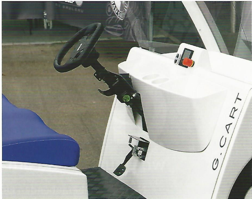
Einfachheit: Startknopf, Verbrauchsanzeige, Gaspedal und Lenkrad; mehr braucht der G.Cart nicht, um zu fahren.
