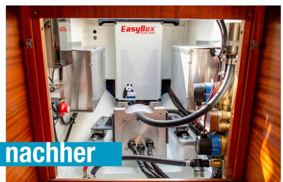
Der Batteriespeicher kann über die 230 Volt Steckdose am Steg oder über zusätzlich installierte Solarpaneele auch während des Törns direkt auf dem See aufgeladen werden.
